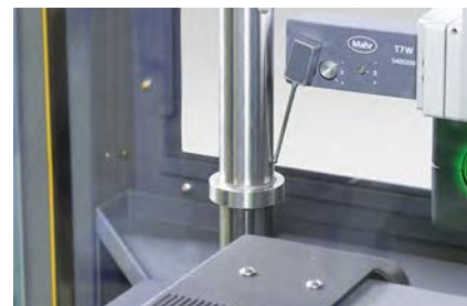
Mesures tactiles avec T7W
