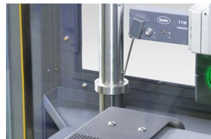
Mesures tactiles avec T7W
